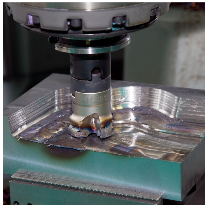
可转位刀片破损造成工件次生损坏
