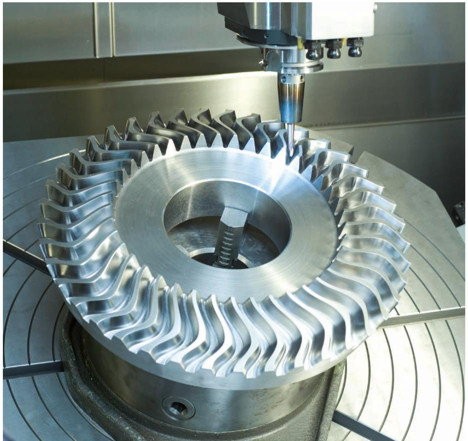
根据成本构成、客户要求、机床的加工情况，特定旋转轴可由力矩电机驱动或由伺服电机与机械传动系统驱动。对于采用机械传动的旋转轴，编码器的选型尤为关键，本文主要聚焦于该主题。对于由伺服电机和齿轮传动系组成的旋转轴，要测量其位置，最简单的方法是用电机编码器和传动比。这就是半闭环控制的位置反馈控制方式。在半闭环控制中，不考虑机械传动部件的误差。反馈控制环中不含这些误差。半闭环控制中的周期性负载导致传动部件发热，这是定位误差较大的重要原因。然而，如果将角度编码器直接安装在回转工作台的转动轴上进行位置反馈，这是全闭环控制。在全闭环控制中，几乎全部机械传动误差都在位置控制环中。
